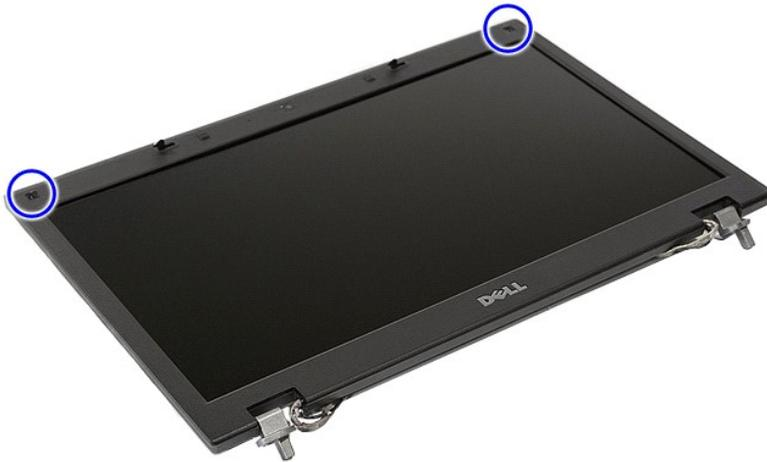
10. Ziehen Sie die Bildschirmblende vorsichtig von der Bildschirmbaugruppe, indem Sie Ihren Finger unter eine Kante des Rahmens stecken und rundherum fahren, um die Blende vollständig zu lösen.
