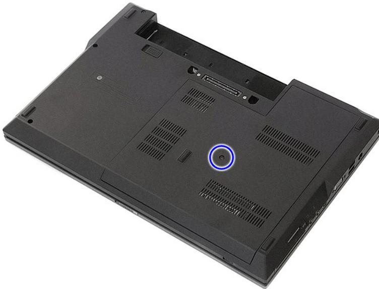
4. Schieben Sie die Service-Abdeckung aus dem Computer heraus und entfernen Sie sie.
