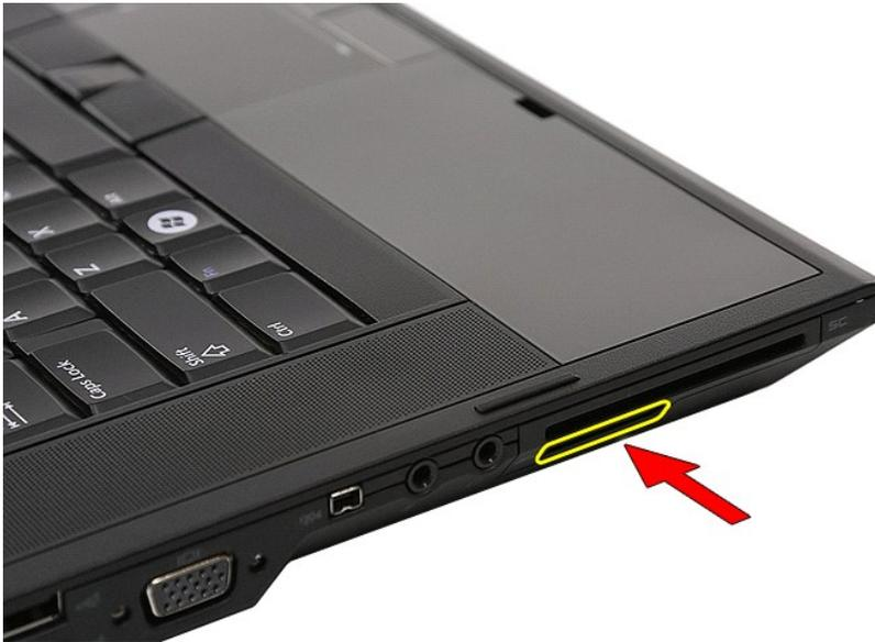
4. Schieben Sie die Speicherkarte aus dem Computer heraus und entfernen Sie sie.
