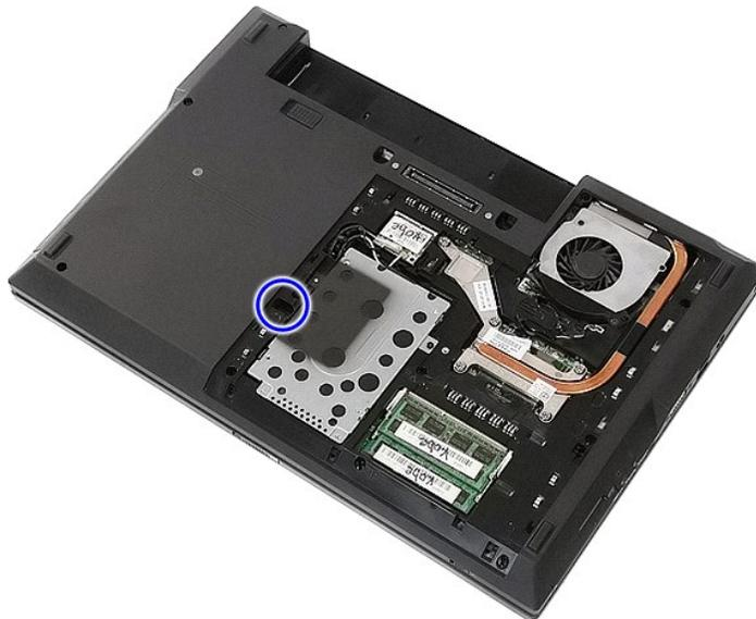
4. Führen Sie einen Plastikschraubendreher in den Schlitz der Verschlusschraube ein, lösen Sie sie vorsichtig und entfernen Sie das optische Laufwerk aus dem Computer.
