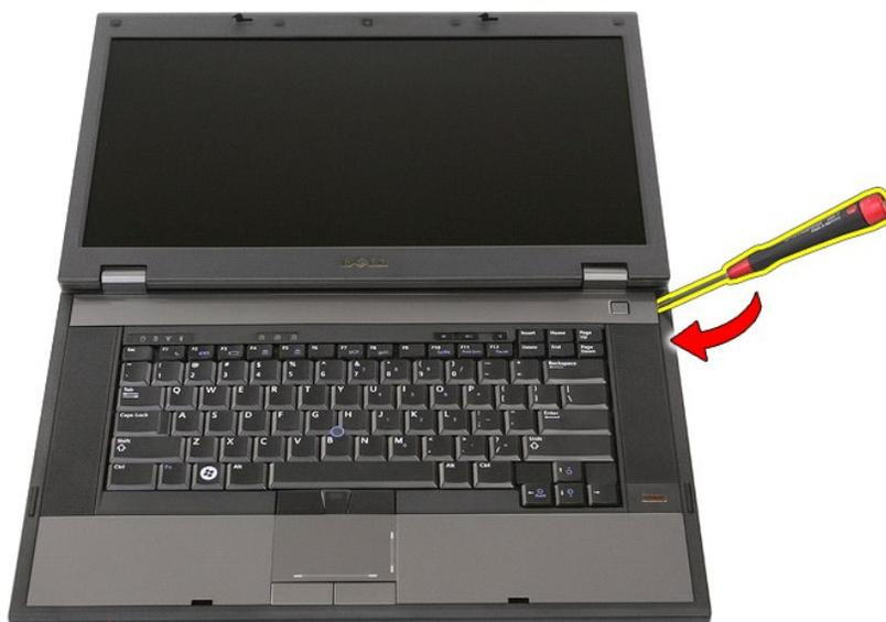
4. Fahren Sie vorsichtig unter den Kanten der LED-Abdeckung entlang, um sie aus den Verriegelungen zu lösen und entfernen Sie sie.
