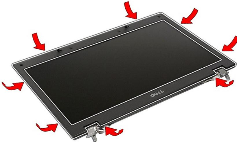
11. Heben Sie die Bildschirmblende an und entfernen Sie sie aus dem Computer.
