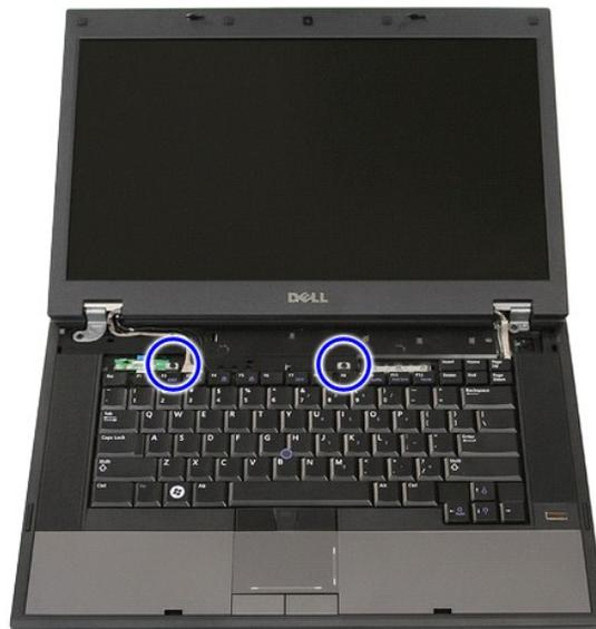
5. Schieben Sie die Tastatur nach oben, heben Sie sie anschließend an und entfernen Sie die Tastatur vom Computer.
