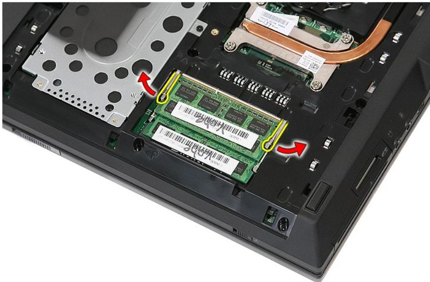
5. Entfernen Sie das Speichermodul aus dem Computer.
