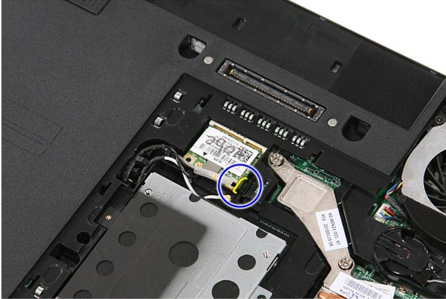
6. Entfernen Sie die WLAN-Karte aus dem Computer.
