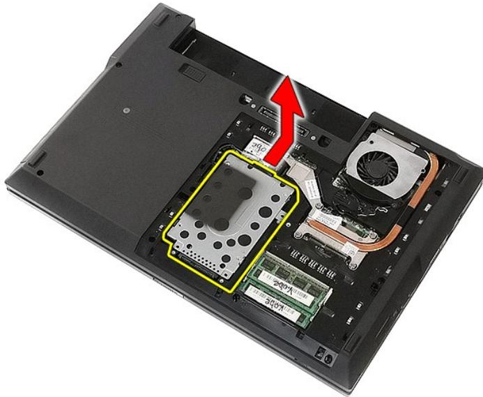
6. Entfernen Sie die Schrauben, mit denen die Festplattenlaufwerkhalterung am Festplattenlaufwerk befestigt ist.
